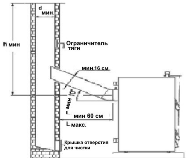
Рис. 6 Пример подключения к дымоходу
